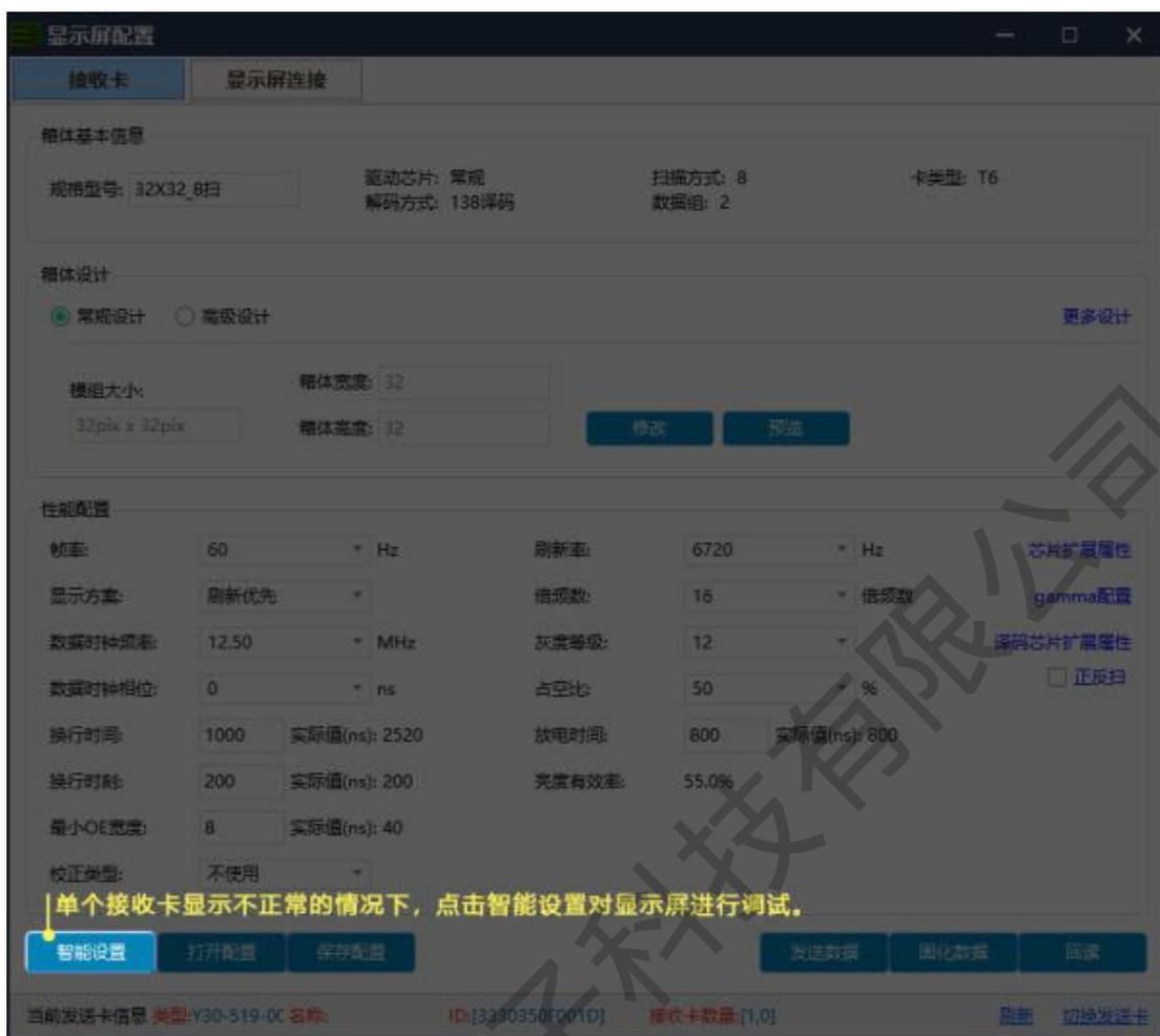
3. 在弹出的智能走点参数配置窗口里，根据当前 LED 模组实际情况设置对应参数。
