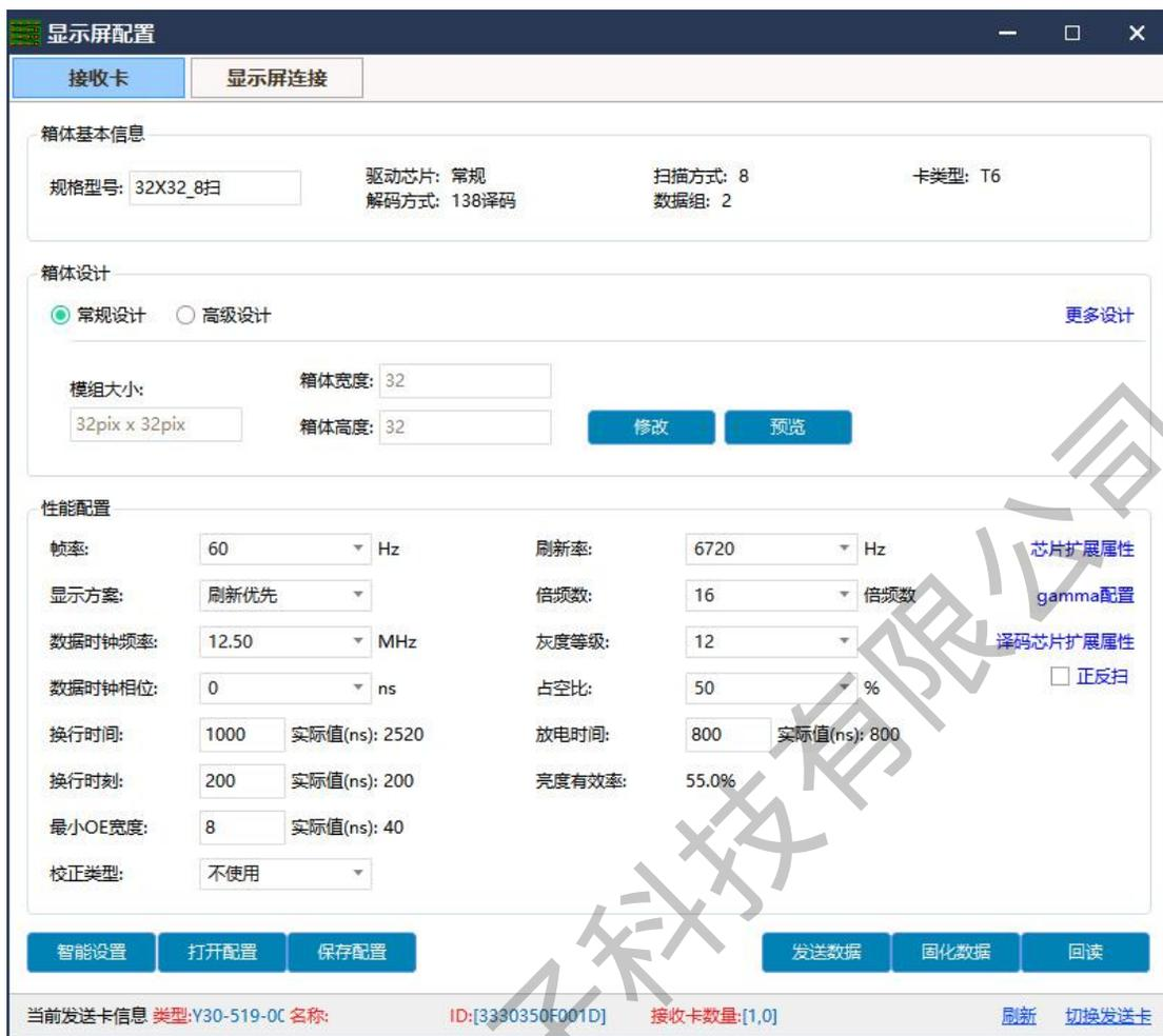
2. 在箱体设计栏中选择常规设计，点击修改，根据接收卡实际带载设置箱体的宽高及排线级联方式和对开方式。
