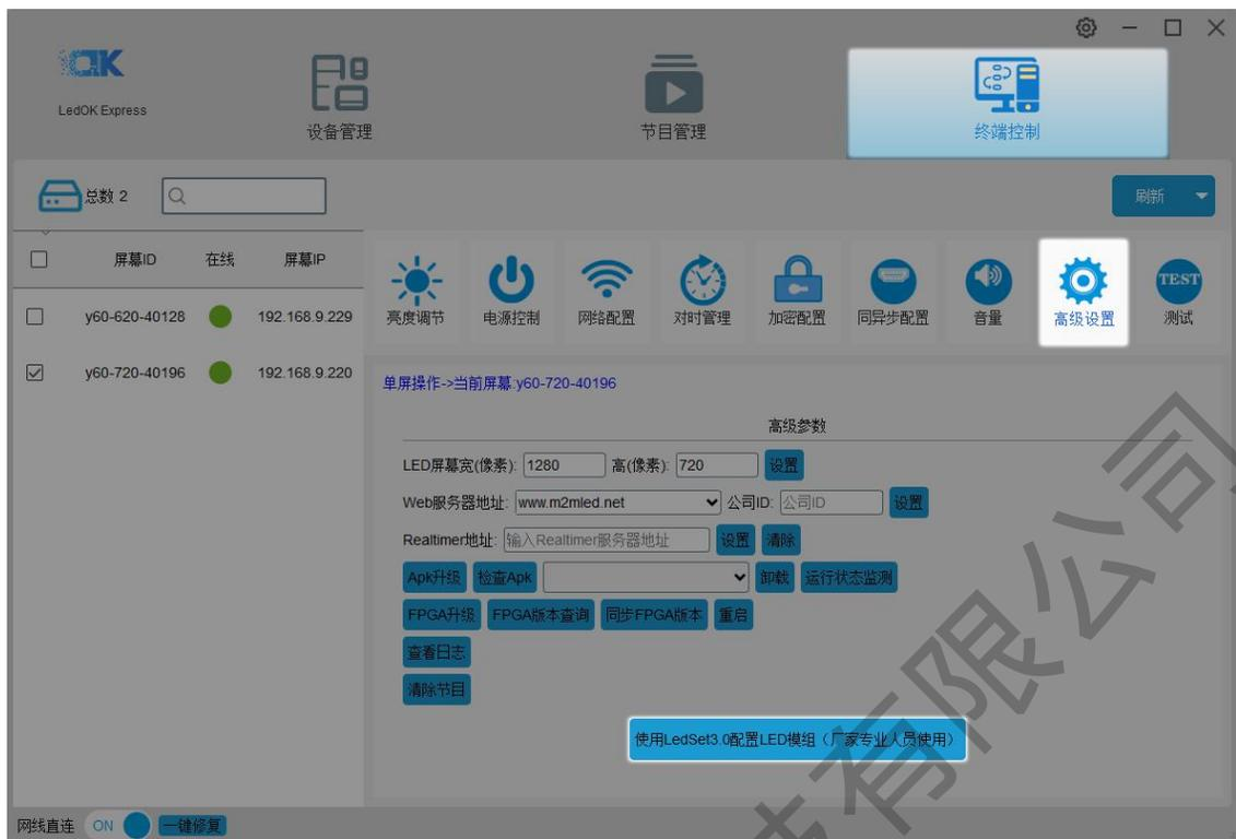
3. 在 LedSet3.0 界面里, 打开发送卡, 确认发送卡和接收卡连接正常、与软件建立通讯。
